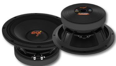
**PARA EVITAR DAÑOS A ESTE ALTAVOZ SE RECOMIENDA REALIZAR UN CORTE EN LA FRECUENCIA EN EL CROSSOVER EN HIGH PASS DE POR LO MENOS DE 200 Hz HACIA ARRIBA**
